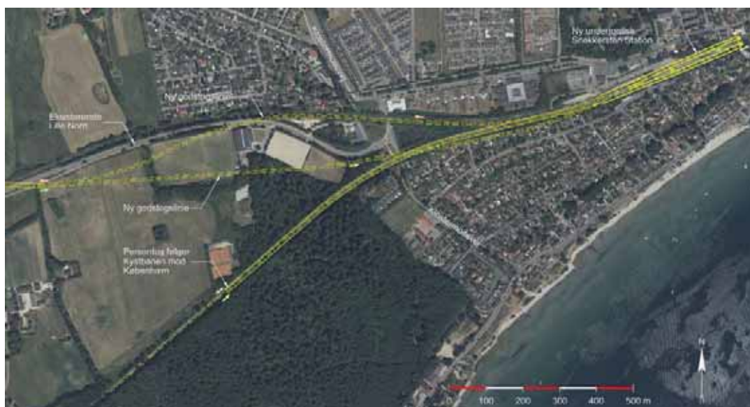
Figur 4-6 Udfletning af godsbane mod Ring 5 og persontog mod Kystbanen syd for Snekkersten Station. Højre godsspor krydser persontogssporene ude af niveau (Bilag B. 4)
