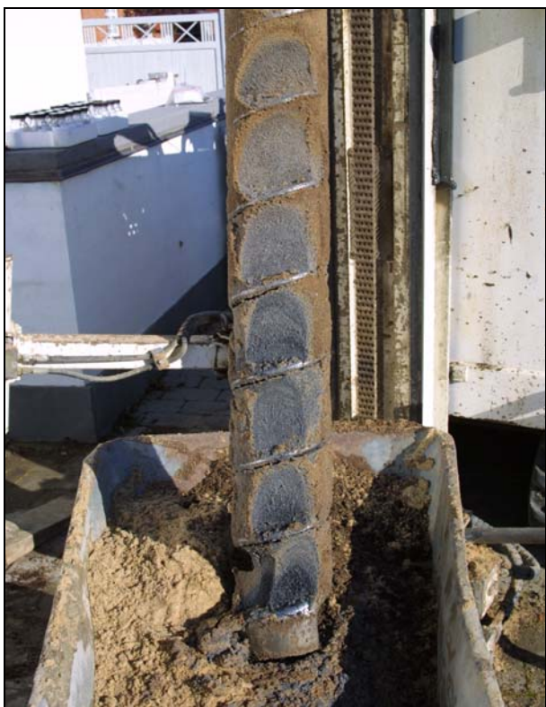
Snegleboring i olieforurenede sandlag
