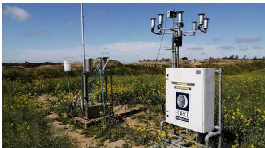
FIGUR 2 OPSTILLING AF STØVMÅLEUDSTYR VED GRUSGRAVEN I HELSINGØR.
