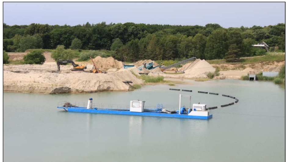
Figur 2-2 Sediment pumper fra den blå pram til det inddæmmede område, som ses i baggrunden til venstre.
