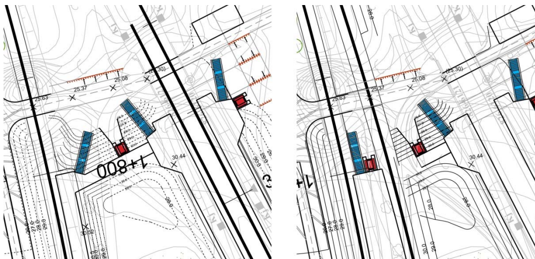
Figur 21. Tegning af trapper (blå) og elevatorers (rød) placering i hhv. hovedforslaget og optionen.
