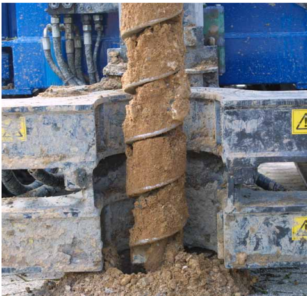
Borebil. Der bores et hul ned i jorden. Fra hullet udtages prøver af jorden som analyseres for indhold af forurenende stoffer
