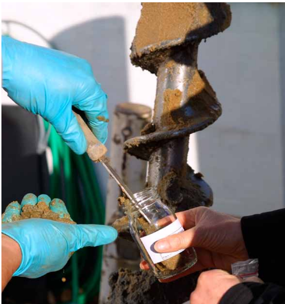
Udtagning af jordprøver fra boresnegl
